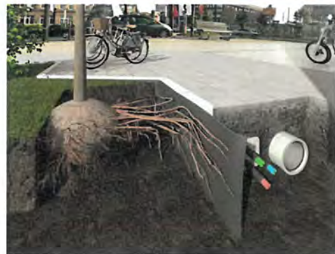
รูปที่ 2.17-8 ตัวอย่างรายละเอียดแผ่นควบคุมทิศทางการเดินของรากไม้ (Root Barrier)
